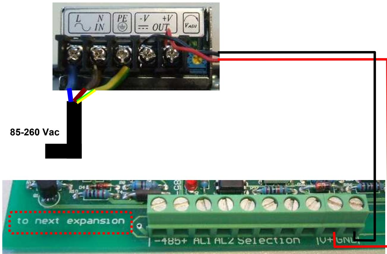
**Fig. 12:** Collegamento Alimentazione – 2° Scheda di espansione
